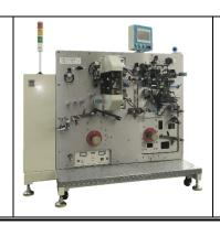
采用单焊接、单贴胶机构,可 选择收卷和极片切片两种生产 模式,适用于的圆柱锂电池制 片工艺。
