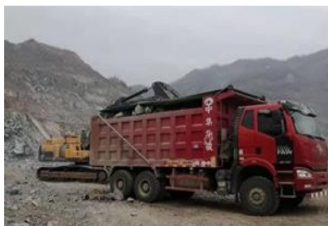
运输车辆自动覆盖篷布设施
