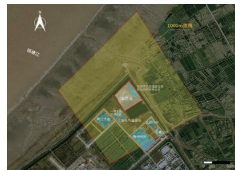
中兰环保承建的余姚市原应急生活垃圾填埋场环境综合整治项目占地面积约 390 亩，2009 年经简易建设投入使用，无防腐防渗措施，2017 年经简单覆土回填后封场。库区内填埋生活垃圾约 90.25 万立方米、建筑垃圾约 11.60 万立方米。项目通过清表、清挖筛分、焚烧处置 + 建筑垃圾场内回收分拣再利用 + 废水处理达标后纳管排放等技术措施全面清理积存垃圾。本项目的实施将在彻底治理填埋场环境污染的同时，释放土地资源，实现场地再利用。
