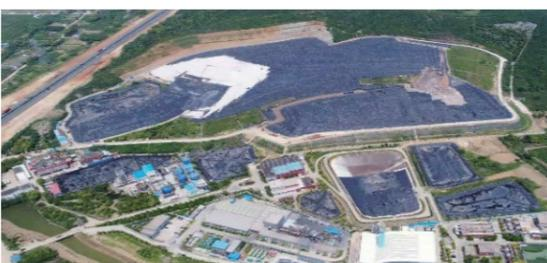
中兰环保投资建设的常州市填埋气发电扩容项目建设装机容量为4MW的垃圾填埋气发电机组，于2020年3月建成投产。2021年，项目发电量为3057.40万度，实现3.05万吨二氧化碳减排，折合节约标准煤约1.00万吨。
