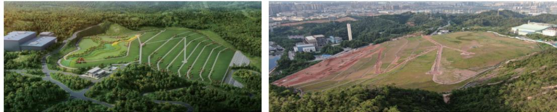
中兰环保承建的珠海市西坑尾垃圾填埋场 AB 区封场项目占地面积约 12.04 万平方米，封场面积约 12.24 万平方米，绿化总面积为 10.39 万平方米。该项目的实施有序地收集并处理填埋气，减少碳排放，生态绿化可有效增加碳吸收，助力碳达峰、碳中和。
