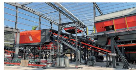
中兰环保承建的深圳市光明田寮垃圾填埋场筛分项目垃圾量约为 15 万立方米，项目的实施彻底解决了填埋场的渗滤液、填埋气对周边环境的污染问题。本项目的实施为场地新的规划利用提供了保障。
