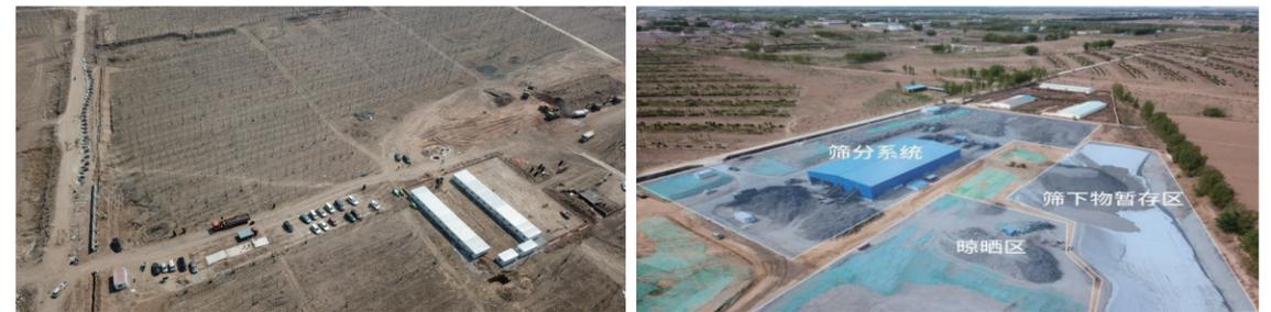
建设雄安新区是国家千年大计，通过项目的实施可为新区建设贡献力量。中兰环保承建的容城县垃圾填埋场腾退项目位于雄安新区内，距离新区规划市民服务中心仅 700 米，现状占地功能与规划严重不符，制约了容东片区的建设，亟需腾退治理。项目采用“垃圾开挖运输+异地无害化处置(好氧稳定化+筛分)”主体工艺。该项目是国内首个正规垃圾填埋场腾退及异位修复项目，开创了国内垃圾腾退治理的先河。
