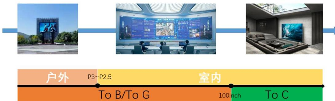
户外显示领域，显示屏幕面积较大，从几平方米到几百几千上万平方米不等，点密度较稀，发光亮度要求较高，LED 直接显示技术占据主导地位，单颗发光颗粒直接形成显示图像。
