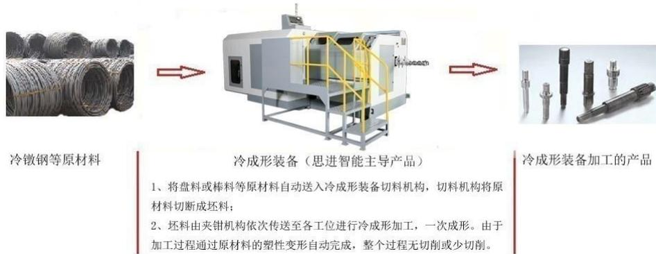
公司持续加大新产品研发力度。截至当前，公司可以生产八工位以内的冷成形装备。冷成形装备的“工位”数指加工产品过程中的变形次数，“工位”数一般与冷成形装备的定模数一致。公司冷成形装备在加工产品过程中，采用回转工作台或回转夹具等，使工件先后在机床上占有不同的位置进行连续加工，每一个位置上进行一次动模冲击定模的加工变形，称作一个工位。如五工位冷成形装备就是将工件经过五次加工变形后，生产出符合要求的产品，某型号零件在其内部变形加工过程如下图所示：
