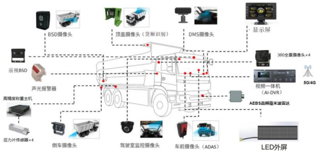
图 2 高级辅助驾驶系统硬件终端构成图
