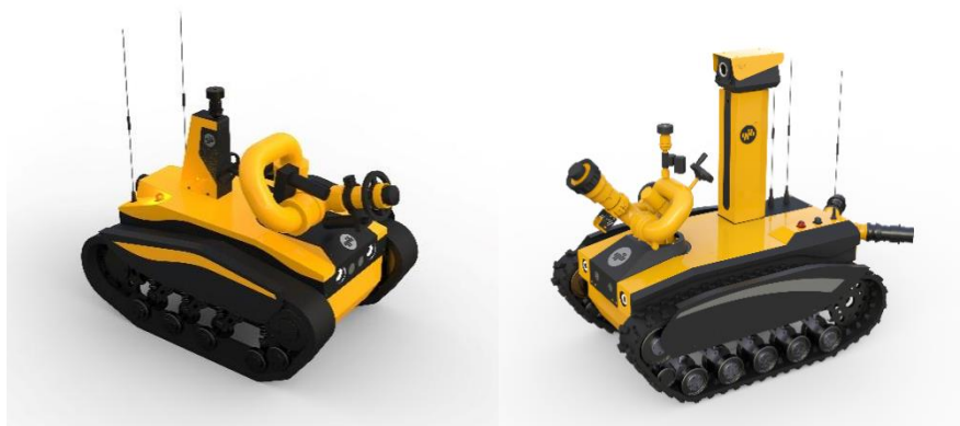
消防灭火机器人
