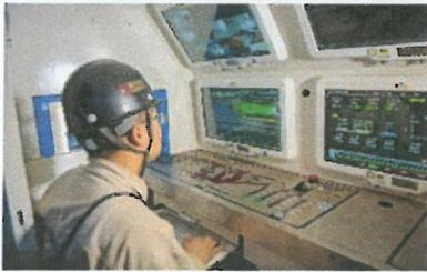
邢东矿建成了国内首个智能化充填开采工作面，实现了以充定产、全矿井充填开采，打造了独具矿井特色的全域连续智能化高效充填开采模式。邢东矿建设了有感知、分析、控制的智能化煤矿管控数据中心，建成了“1+11+38”矿井集成控制系统，总控平台实现了对矿井生产环节设备参数、状态、场景的实时监测，11个分系统通过一体化界面实现了对38个子系统的实时监测与集中控制，变电所建成了机器人智能巡检作业系统，实现了变电所、通风系统、供排水系统等固定岗位的无人值守作业。目前，矸石充填自动化系统已达到年产百万吨水平，被中国煤炭工业协会授予“科学技术一等奖”，为进一步解放公司煤炭资源，增强企业发展后劲奠定了基础。
