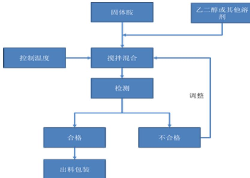
3. 己二酸工艺流程图如下所示:
