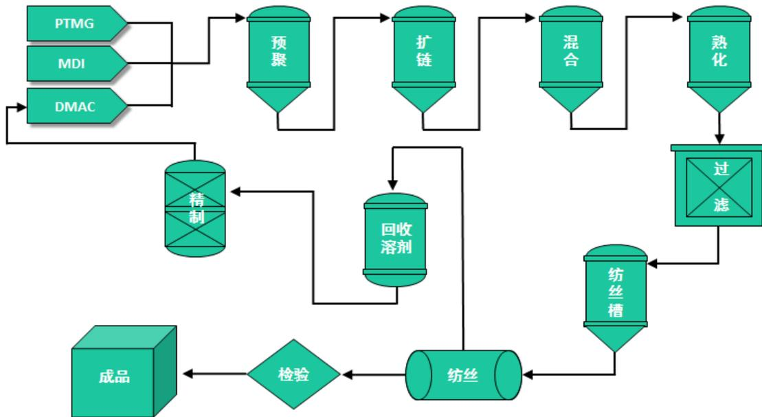
2. 聚氨酯原液包含三种组分，分别为聚酯（或聚醚）多元醇混合物（A组分）、异氰酸酯预聚物（B组分）和催化剂（C组分）。工艺流程图如下所示：
