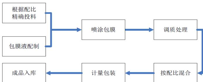
(3) 硝基复合肥生产工艺流程图
