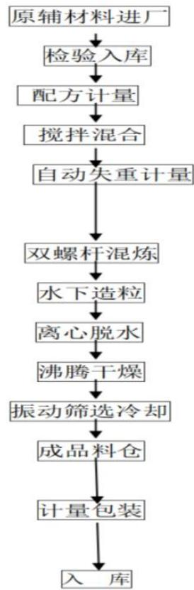
4、二步法硅烷交联电缆料生产工艺流程
