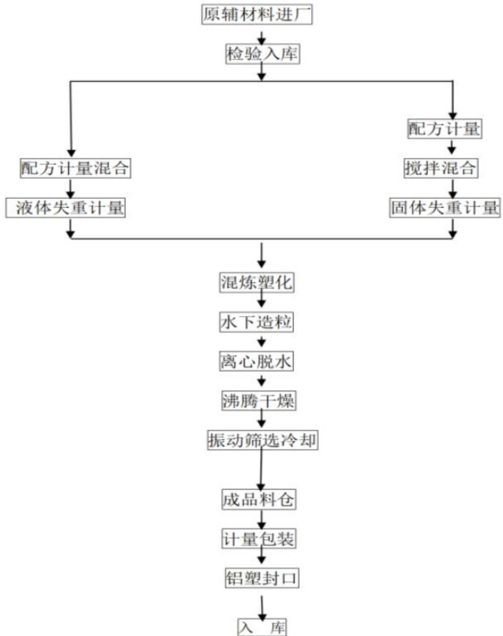
5、橡胶电缆料工艺流程
