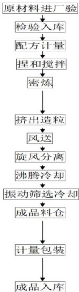
2、无卤低烟电缆料工艺流程
