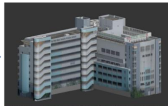
工序6: 在模型上构建特定目标具体图像, 去除遮挡、行人等无效信息, 美化模型
