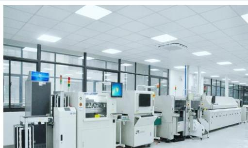
2、公司新设立了SMT贴片车间。SMT贴片是PCBA的主要生产技术，随着公司组件产品对PCBA产品需求的增加，公司引入了日本YAMAHA SMT贴片流水线，使公司的生产能力全面覆盖SMT组装全流程，标志着公司在PCBA生产领域实现新的突破，真正实现为客户提供涵盖线束、结构件开模、注塑、线圈、贴片PCBA等一站式的电子产品配件解决方案。
