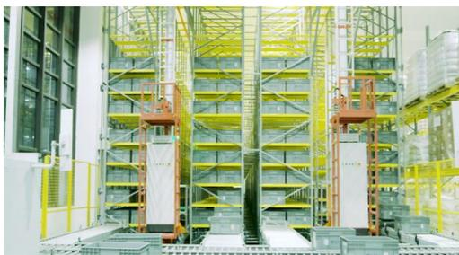
4、公司建立了智能仓储与运输系统。公司建立了拥有超4000个箱位的全自动智能立体仓库，通过全自动堆垛机，智能仓储系统大幅减少了仓库管理、存货出入库管理所需的人工数量，更高效地满足了公司小批量多品种定制化生产的特点。同时，公司结合生产信息化管理系统（ERP）、智能仓储物流系统（WMS）、数据采集与监视控制系统，可以实现最快5分钟完成原材料分拣，并通过AGV小车最短5分钟自动送达生产线的目标，有效解决了传统生产物流人工用时长、调度差错率高等问题，提升了公司的生产效率、产品质量控制及工厂精细化管理水平。
