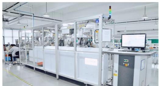
3、公司先后重金引入了如瑞士Komax全自动端子机，日本Makino加工中心与火花机，德国Zeiss三坐标，德国Lumberg IDC刺破式连接器线束自动生产线等一批行业顶尖的智能化生产与检测设备。其中，德国Lumberg IDC刺破式连接器线束自动生产线为国内第一台应用于汽车行业的全自动IDC刺破式连接器线束生产线，实现了此类IDC线束从裁断、穿线、压接到检测这一整套生产流程的全自动化，生产效率大幅提升，并达到了汽车行业所倡导的OPPM（无缺陷）标准。公司应用此技术为北京奔驰新一代C级轿车提供成套尾灯线束，2021年下半年实现大批量生产。
