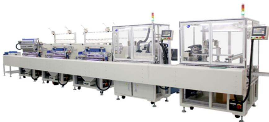
全自动变压器流水线
