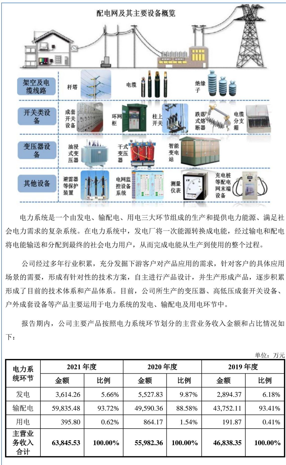
发电、输配电、用电等环节通常采用不同的电压等级，并通过变电环节实现电压等级之间的转变与连接。以我国集中式供电电力系统为例，发电机输出的中压电能需经变电环节升至 110kV-1000kV，方能实现大规模、低线损的远距离输电，电能输送至用电区域后需降至 11kV-110kV 分配和接入各类工业企业、公建设施等用电负荷较大的终端用户，最后再降至低压 220/380V 分配和接入低压用户。
