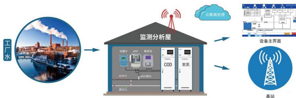
环境水质在线监测仪工作示意图
