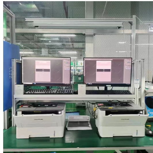
工装打印机上安装扩音器，便于作业员辨别异音现象
