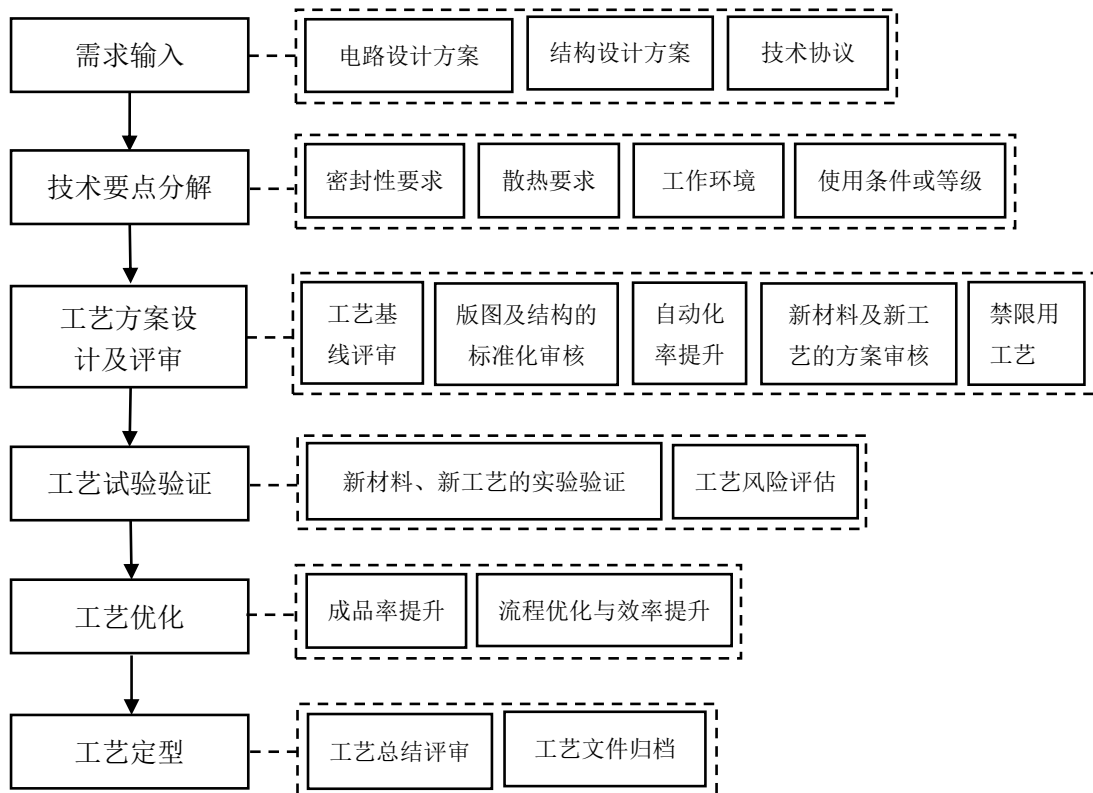
图 6-10 工艺研发流程图
