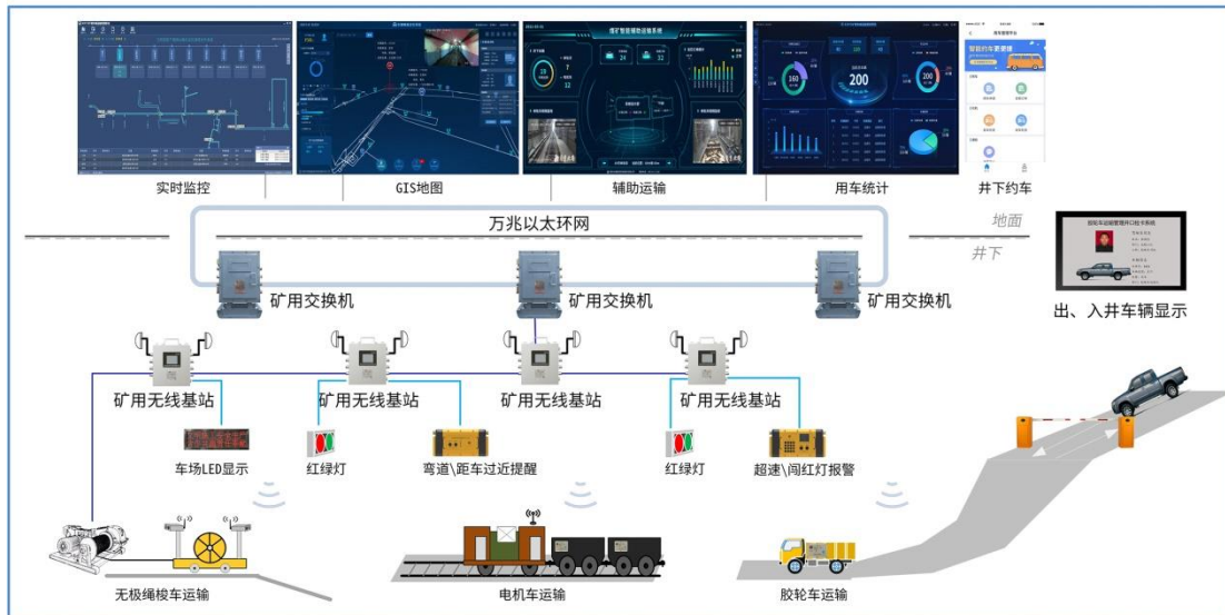
智能矿山辅助运输监控系统
