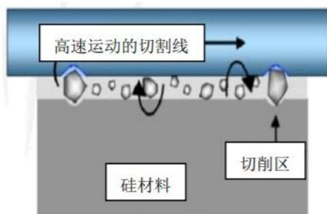
新型金刚线切割原理示意图
