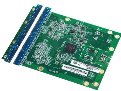
图：线阵 PD 探测模组
