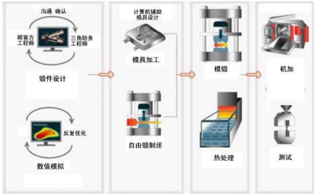
图 1-9 模锻件生产流程
