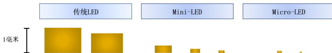
不同类型 LED 芯片尺寸比较示意图
