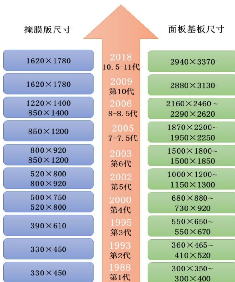
图 显示面板及掩膜版世代发展简图（单位：mm）
