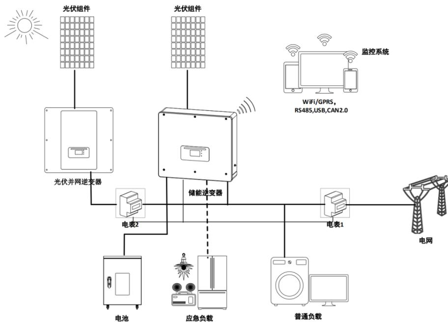
在光伏发电系统中，在太阳光照射下光伏组件将太阳能转换为电能产生直流电，通过光伏逆变器的处理转换为交流电后实现对外输出，通过配电箱等装置并入市电电网，并且可以通过储能逆变器和储能电池等控制储能。近年来，随着光伏发电技术的发展，“光储一体化”已成为行业的主要发展方向。
