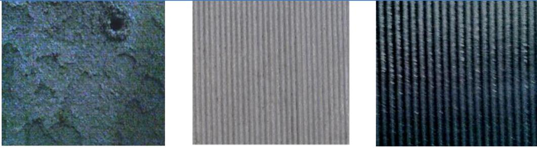
注：左图是未经增表处理的阳极使用 5 年后的表面形貌，中间图是经过增表处理阳极板表面形貌，右图是经增表处理的阳极板使用 5 年后的表面形貌。
