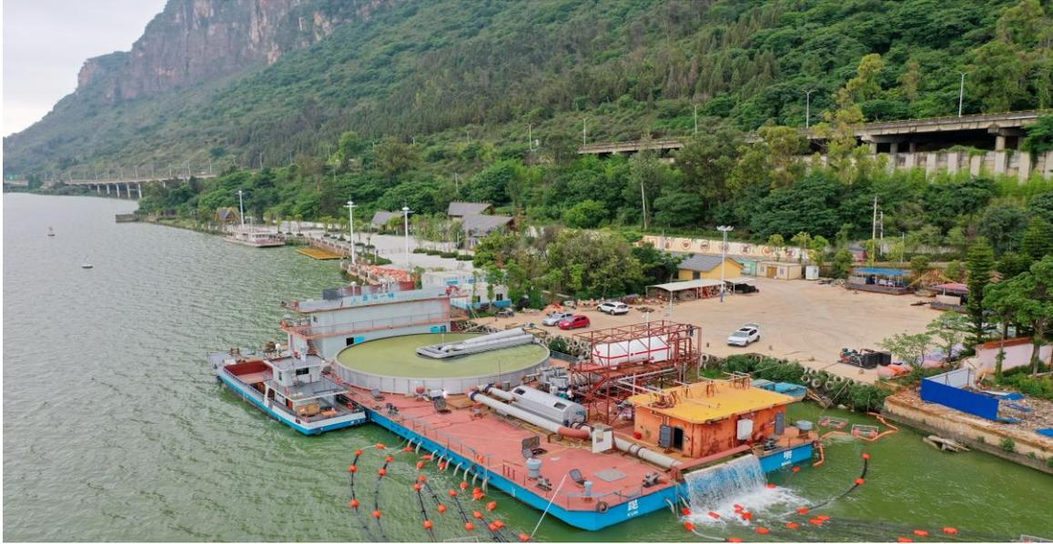
2022年6月我国首艘“藻水同治”蓝藻打捞处理工程船“丞泊一号”在昆明滇池投入航行。该系统由昆明水啸科技运营，采用了国际先进MST超大通量离子气浮蓝藻处置设施及MST水体快速增氧一体化生态高速修复模块。每天开打捞处理蓝藻水 $50,000\text{m}^3$ ，蓝藻去除率 $>99.5\%$ 。该船采用微纳米级的微气泡对蓝藻进行高速气浮处理，快速修复水生态环境。出水浊度 $<0.3\text{NTU}$ ，大幅去除COD、 $\text{NH}_3\text{-N}$ 、TN等污染物并高饱和增氧(DO)。
