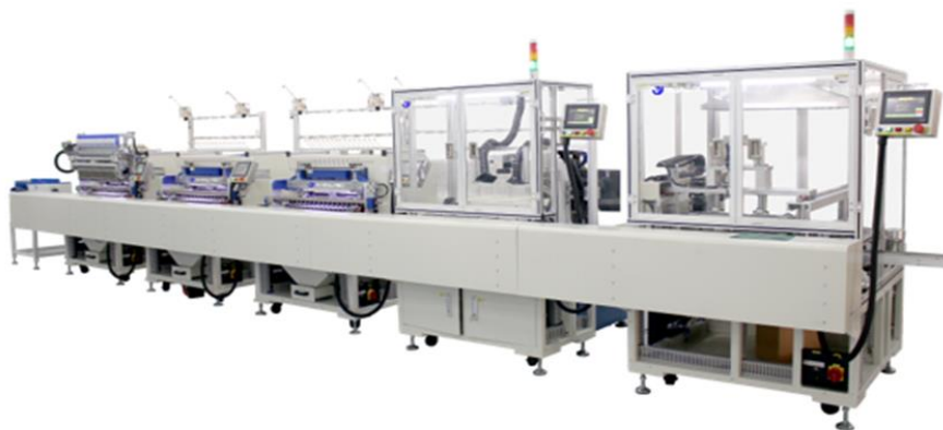
全自动变压器流水线
