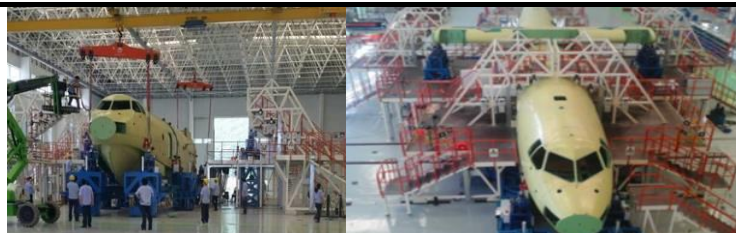
AG600 柔性自动化总装配生产线
