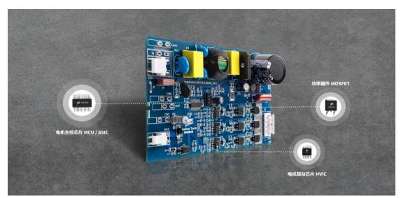
注 1: 上图仅为示意图,公司的电机主控芯片已在单芯片晶圆层面部分集成/全集成电机驱动芯片 HVIC、功率器件 MOSFET 等电路;
