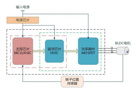
公司 MCU/ASIC、HVIC、MOSFET 芯片,共同组成 BLDC 电机驱动控制的核心器件体系,其中: MCU/ASIC 芯片属于控制系统大脑,实现电气信号检测、电机驱动控制算法及控制指令生成等;由于主控芯片难以直接驱动大功率的 MOSFET,需要 HVIC 作为驱动芯片,起到高低压隔离和增大驱动能力的功能。在三大核心器件共同作用下,给 BLDC 电机提供高压、大电流的驱动信号,产生 U、V、W 三相控制电压,使 BLDC 电机按照控制指令工作。随着公司技术发展,公司已在芯片电路设计单芯片层面实现部分集成/全集成 HVIC、MOSFET 的高集成度电机主控芯片产品,并可提供电机驱动专用智能功率模块 IPM。
