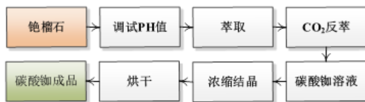
(铯盐的主要产品制备工艺流程图)
