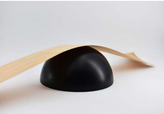
自主研发的微薄纵向刨切技术—厚度为 0.2mm 的刨切薄竹片，长度 2M，通过无限接长技术实现连续供料超薄竹材应用广泛（吸管等）
