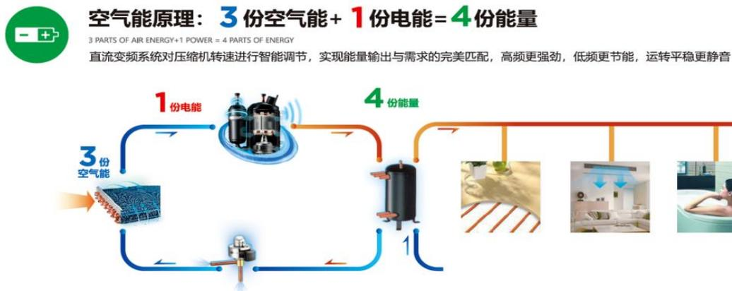
图6：空气能原理
