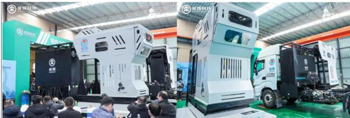
无轨智能“小蚁”重卡换电机器人（AGV）为重卡换电成功
