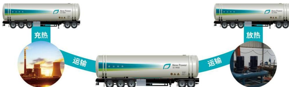
移动储能供热业务中，热源方主要为大型燃煤发电厂、垃圾焚烧电厂、钢铁冶炼及化工等企业，热源方生产过程中或者谷电时段的富余热能以蒸汽、水的形式，安全、稳定、高效地充入移动储能车中储存，通过公路运输的方式将热能释
