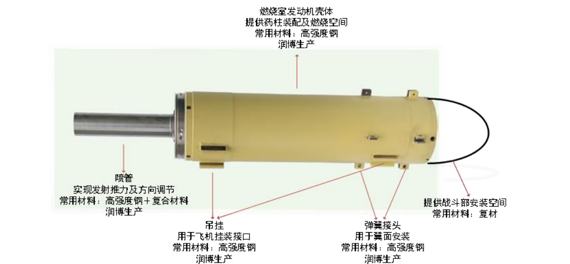
燃烧室发动机壳体及喷管壳体产品二
