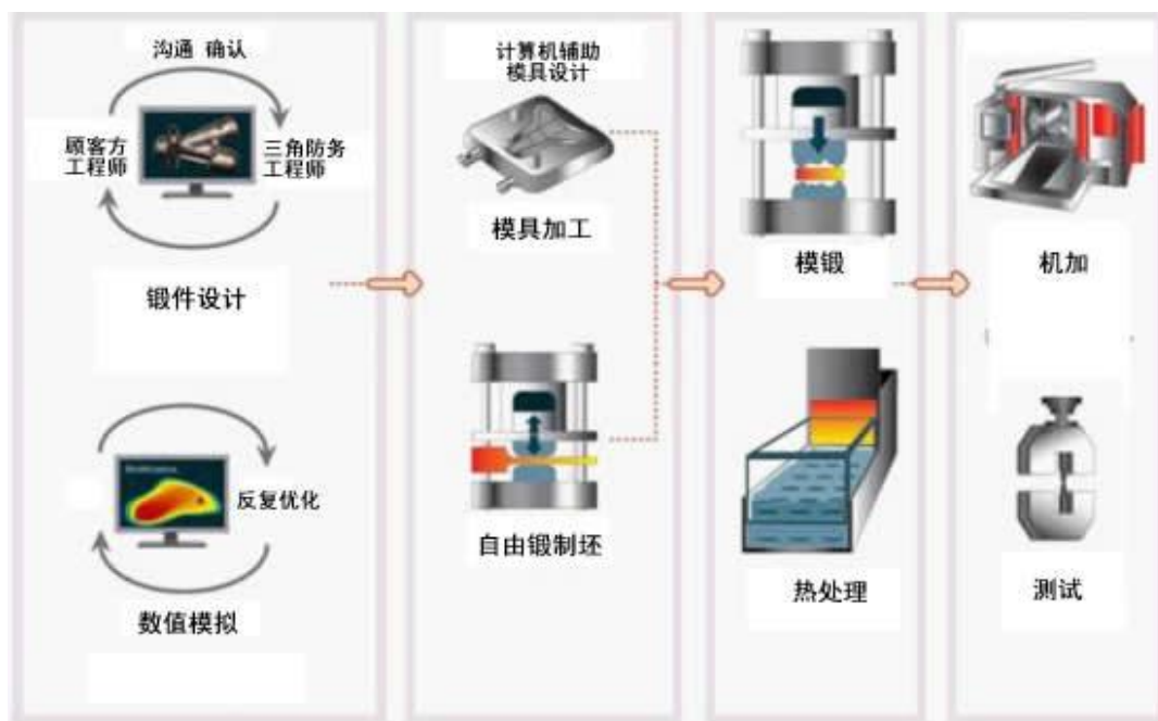
图 1-9 模锻件生产流程
