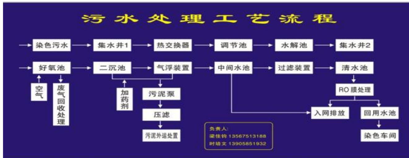
纳管执行标准《纺织染整工业水污染物排放标准》（GB 4287-2012）中表 2 间接排放标准，COD $\leq$ 200mg/L, 氨氮 $\leq$ 20mg/L , pH: 6-9, 苯胺类和六价铬执行“环境保护部公告 2015 年第 41 号”的规定；废水经二级污水处理厂处理达 GB18918-2002《城镇污水处理厂污染物排放标准》中一级 B 标准。
