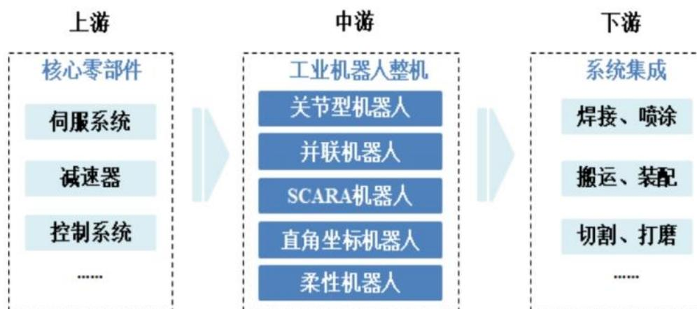
(1) 产业链上游主要为伺服系统、减速器、控制器等核心零部件和齿轮、涡轮、蜗杆等关键材料。减速器、伺服系统（包括伺服电机和伺服驱动）及控制器是工业机器人的三大核心零部件，直接决定工业机器人的性能、可靠性和负荷能力，对机器人整机起着至关重要的作用。
