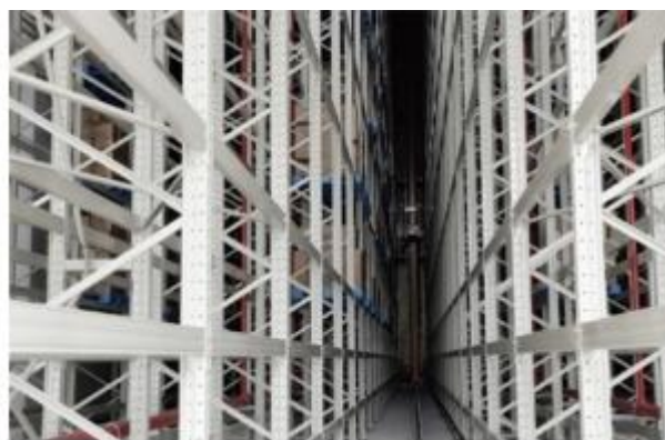
智能立体仓储系统
