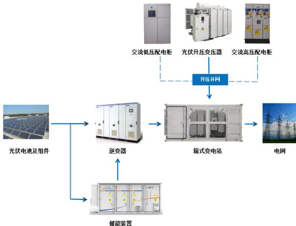
上图中，光伏电池将太阳能转换成低压直流电，因电网及大多数用电设备为交流电，逆变器将直流电转换成交流电，一般输出为 270V、400V，并网时再通过升压变压器，将 270V 交流电升高为 10kV 后并入电网。
