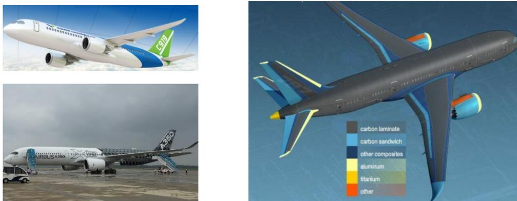
全球经验来看，商用飞机无疑是碳纤维应用最有力的推动者。中国商飞研制的 C919 碳纤维使用量为 12%左右，根据商飞官网 C919 已有超 1,000 架订单，每架空机重量 42 吨，则总计需要碳纤维复合材料超 5,000 吨。随着 C919 各项适航认证工作的顺利进行，批量生产指日可待。宽体机项目 CRJ929 的机身、机翼和尾翼都计划使用碳纤维复合材料，预计用量占比约为 50%。国产民机的发展将给航空碳纤维带来重大发展机遇，随着 C919 有望在 2022 年开始交付，国产民机领域碳纤维需求将呈倍数的提升，预计将进一步提振碳纤维下游需求。
