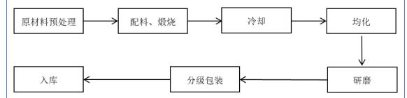
电子陶瓷用粉体材料生产的主要工序介绍如下:
