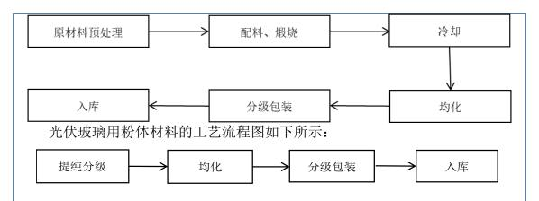
电子及光伏玻璃用粉体材料生产的主要工序介绍如下:
