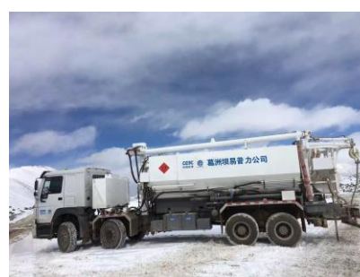
现场混装炸药
