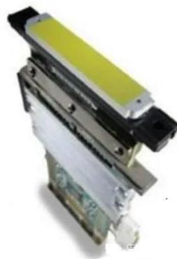
图：面阵 PD 探测模组
