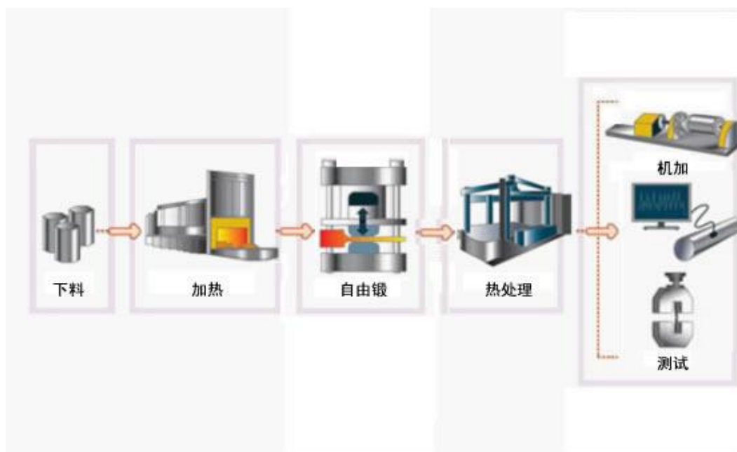
图 1-1 公司自由锻件生产流程
