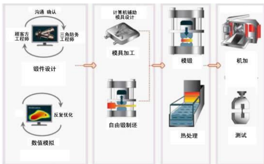
图 1-2 公司模锻件生产流程
