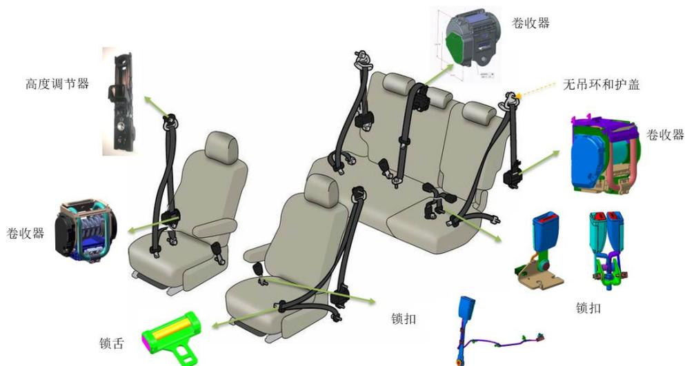
公司各款汽车安全带总成以功能进行区分，主要产品包括普通紧急锁止式安全带、紧急锁止限力式安全带、预张紧限力锁止式安全带和双边预张紧双极限力式安全带。部分高端型号具备单双边预张紧、单双边限力、噪音抑制、儿童锁、防反锁等附加功能，以提供更高效的安全防护功能并增强佩戴及驾乘的舒适性。
