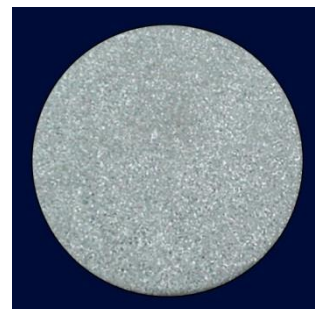
细化后晶粒形态 (240 μm)
