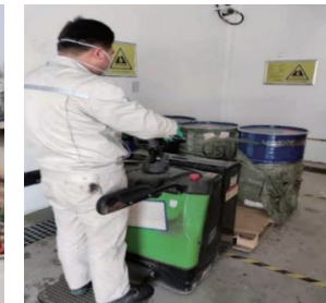
漏液桶转移至泄漏托盘
