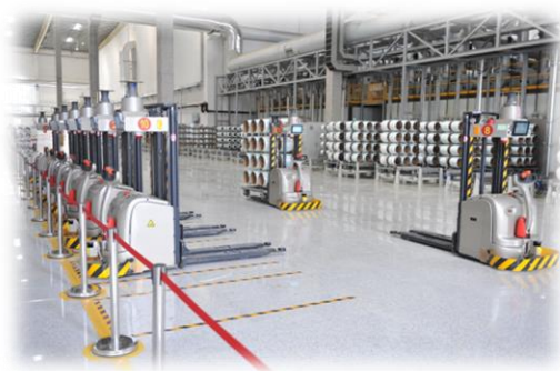
AGV 搬运系统
